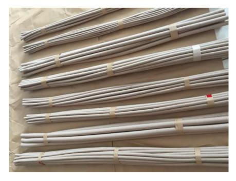
绝缘皱纹纸在变压器引线中的作用,首先应该从绝缘皱纹纸的特性说起:绝缘纸板的性能:1、绝缘纸板具有较好的机械强度,较高的耐电压强度,表面平整光滑、富有韧性。2、绝缘纸板裁剪方便,拆弯后特别在油浸中仍然保持一定的强度,这个特点非常好的保护变压器引线不会被挤压拆断,即满足了绝缘性要求,又满足了机械性能要求。电工常用的绝缘材料按其化学性质不同,可分为无机绝缘材料、有机绝缘材料和混合绝缘材料。常用的无机绝缘材料有:云母、石棉、大理石、瓷器、玻璃、硫黄等,主要用作电机、电器的绕组绝缘、开关的底板和绝缘子等。有机绝缘材料有:虫胶、树脂、橡胶、棉纱、纸、麻、人造丝等,大多用以制造绝缘漆,绕组导线的被覆绝缘物等。混合绝缘材料为由以上两种材料经过加工制成的各种成型绝缘材料,用作电器的底座、外壳等。绝缘材料的作用是在电气设备中把电势不同的带电部分隔离开来。因此绝缘材料首先应具有较高的绝缘电阻和耐压强度,并能避免发生漏电、击穿等。其次耐热性能要好,避免因长期过热而老化变质;此外,还应有良好的导热性、耐潮防雷性和较高的机械强度以及工艺加工方便等特点。根据上述要求。
